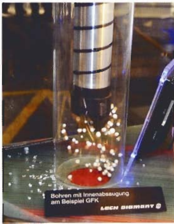
Saubere Sache: PKD-Bohrer mit Innenabsaugung. Bild: Lach-Diamant.
